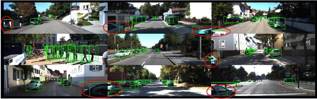
图 3-7 定性结果。可视化 KITTI 测试集上的 3D 目标检测结果，使用红色椭圆来强调那些严重截断的对象
