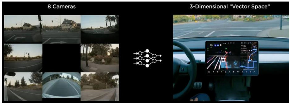
图 1-2 特斯拉纯视觉方案，只采用八个相机实现自动驾驶
