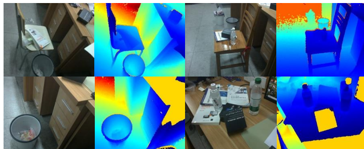
图 2-6 数据集部分影像图片，包含彩色图与其对应的深度图
