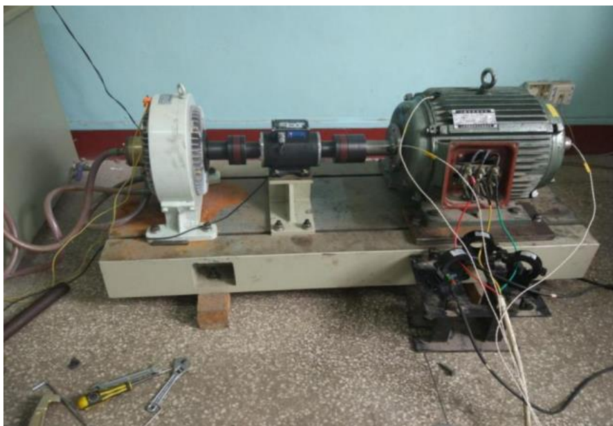
图 5-1 电机故障实验装置图
