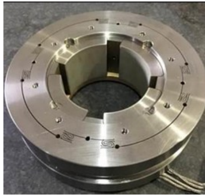
图 1-4 S 型弹性体的 ISFD [41]
