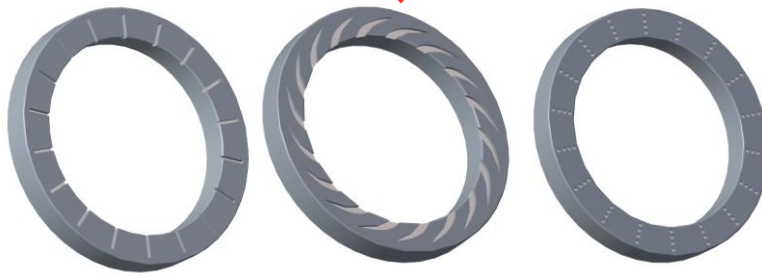
图 1-3 机械密封环及表面织构
