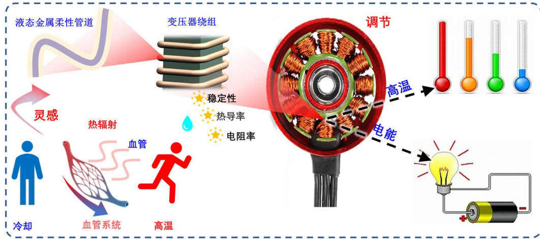
图 3-6 基于液态金属柔性导线的直流无刷电机设计构思图
