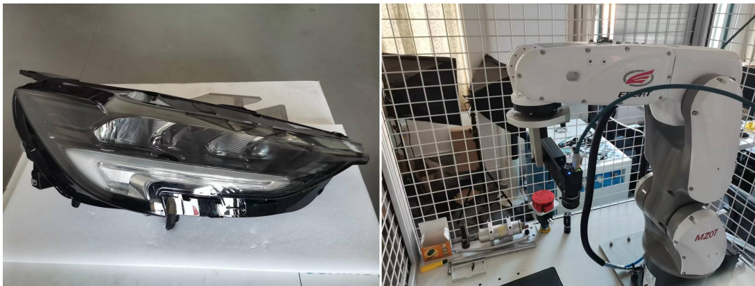
图 3-9 车灯设备与图像采集装置示例
