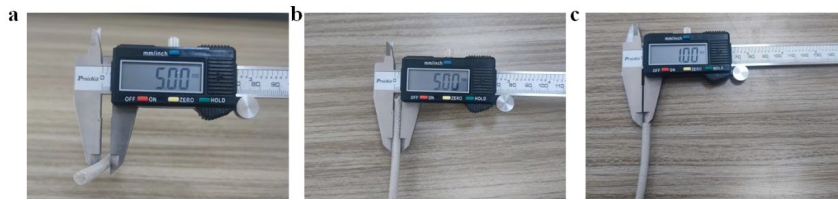
图 2-4 同轴 TENG 外层 PET@Ag@PDMS 的电子图片
