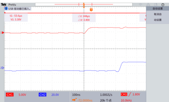
图 4-15 DSP 输出 PWM 到驱动芯片输出 PWM 时间延迟测试
