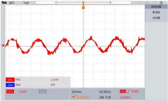
图 4-13 逆变器输出相电流波形
