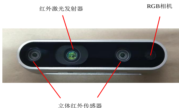
图 5-2 Intel RealSense D435i 深度相机
