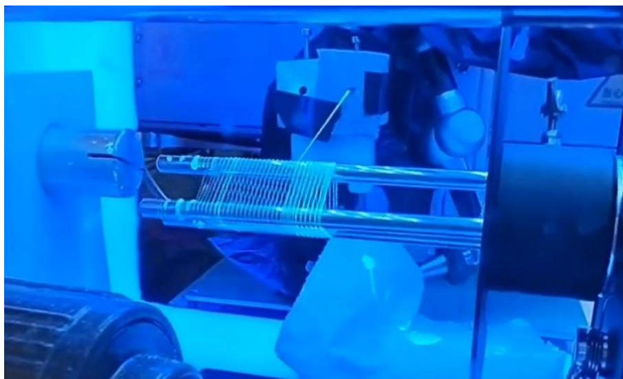
图 4-2 微流控纺丝制备 PMAC-HFP 纤维的光学照片
