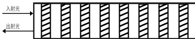
图 4-6 光纤光栅内部结构
