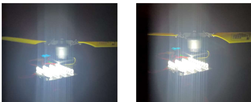
(a) 无刷直流电机加速时桨叶响应 (b) 无刷直流电机减速时桨叶响应
