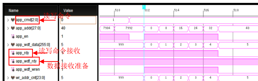
图4-16 DDR3写过程波形图
