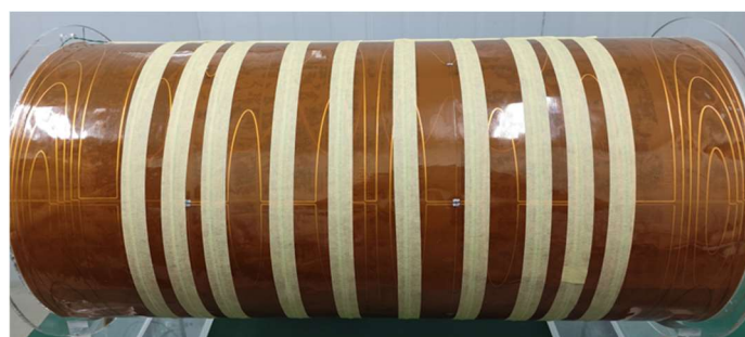
图 3-4 三轴磁补偿线圈安装在圆柱型支撑模具上
