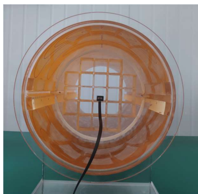
图 5-5 原子磁强计被固定在支撑模具上
