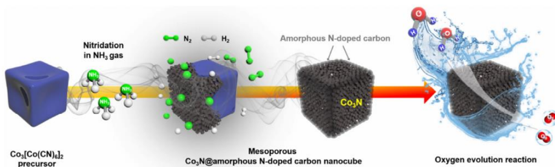
图 1-7 以 \text{Co}_3[\text{Co}(\text{CN})_6]_2\text{PBA} 为原料，采用热氨解法制备了介孔 \text{Co}_3\text{N}@\text{非晶态 N 掺杂碳纳米管} 。
