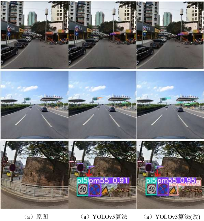
图 3-14 改进 YOLOv5 算法检测结果对比
