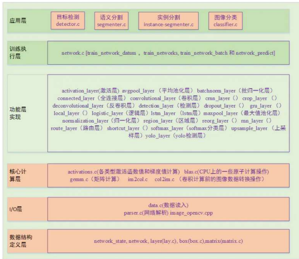
图 3-7 Darknet 框架图及源码结构划分
