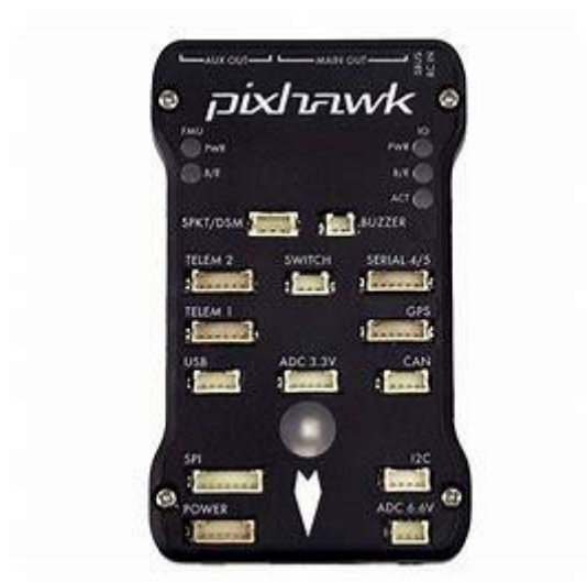
图 5-4 PX4 飞行控制器
