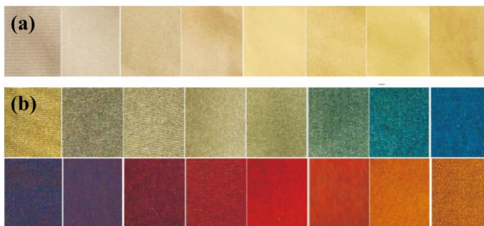
图 1-9 (a) Cu 膜涤纶织物; (b) CuO 膜涤纶织物 [52]
