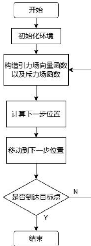
图 1-7 人工势场法算法流程图
