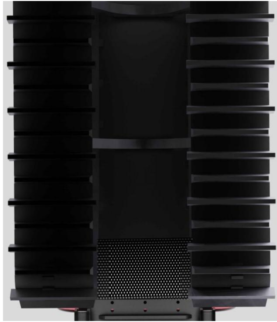
图 5-17 互花米草清理机底部沥孔
