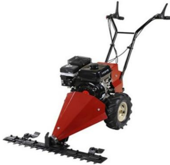
图 2-9 鑫叁元手推式互花米草清除机 (HC - C001)
