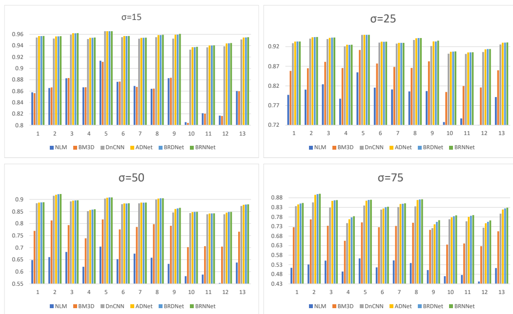
图 4-5 当 \sigma=15 、25、50 以及 75 时, 各种方法在 Set12 上的 SSIM 结果
