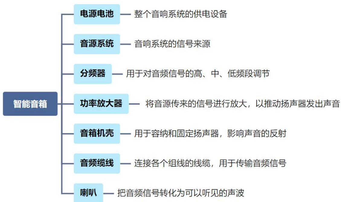
图 5-22 智能音箱的结构
