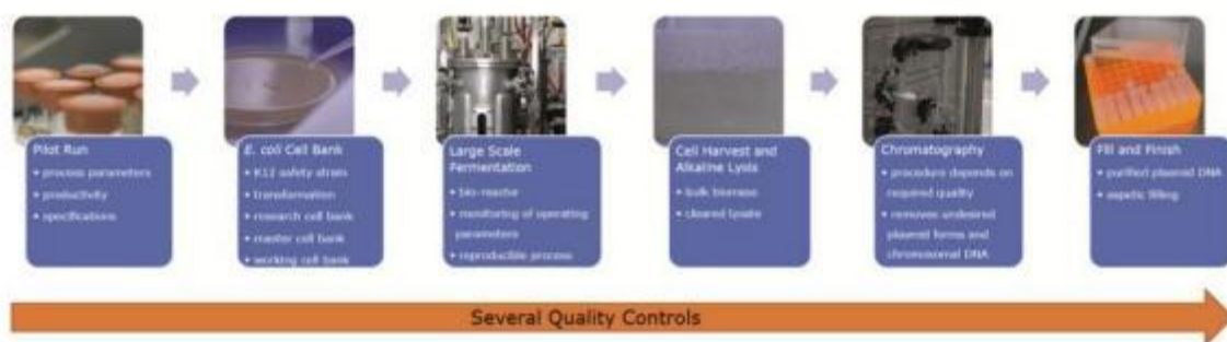
图 1-3 质粒 DNA 制造过程流程图。该工艺包括试运行，大肠杆菌细胞库，大规模发酵，细胞收获和碱裂解，色谱和填充整理，每个工艺步骤都伴随着全面的过程控制 [68]
