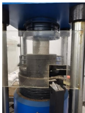
(a) 混凝土立方块抗压试验图
