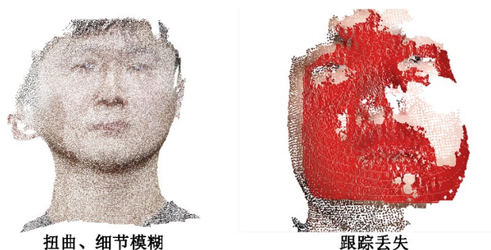
图 2-5 深度相机原始配套算法问题
