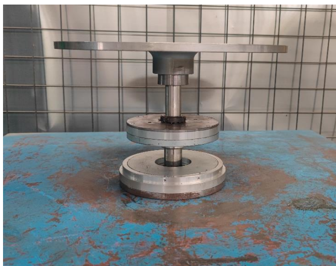
图 3-4 磁浮弹簧实验平台
