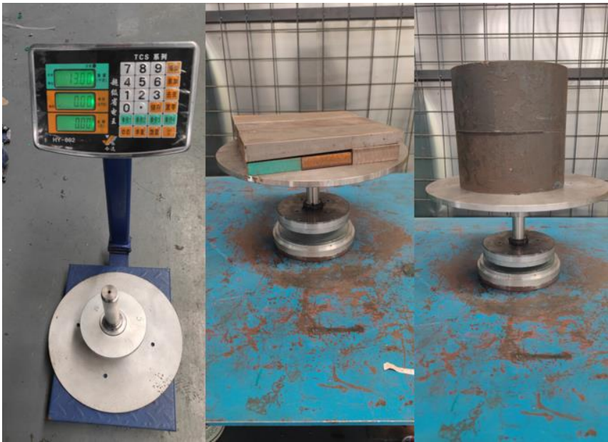
图 3-5 磁浮弹簧自重及受力测试图
