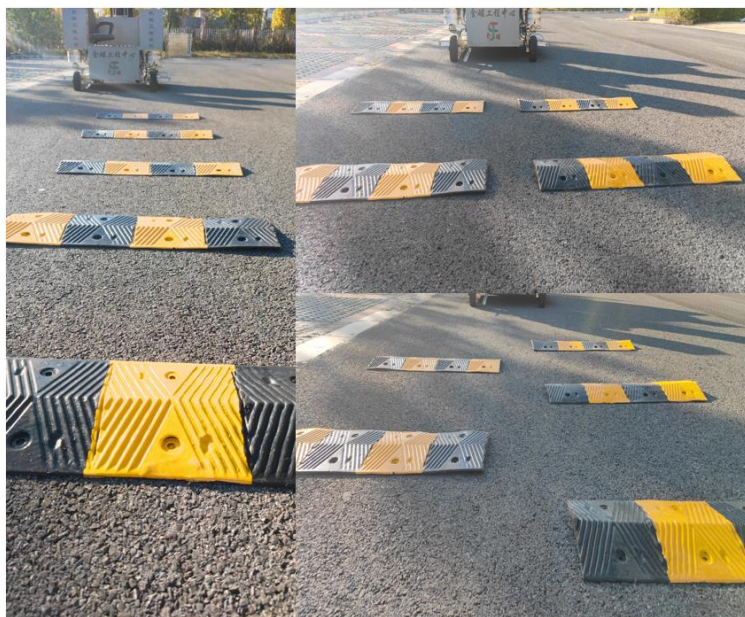
图 4-17 减速带三种排列方式
