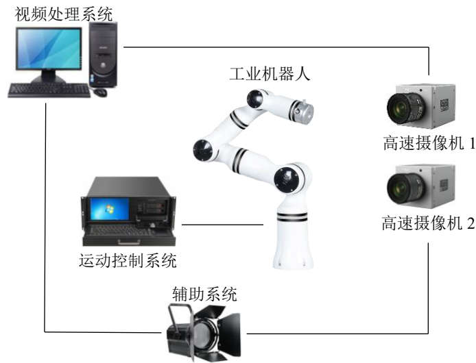
图 2-1 双目同质多目标跟踪与定位系统示意图
