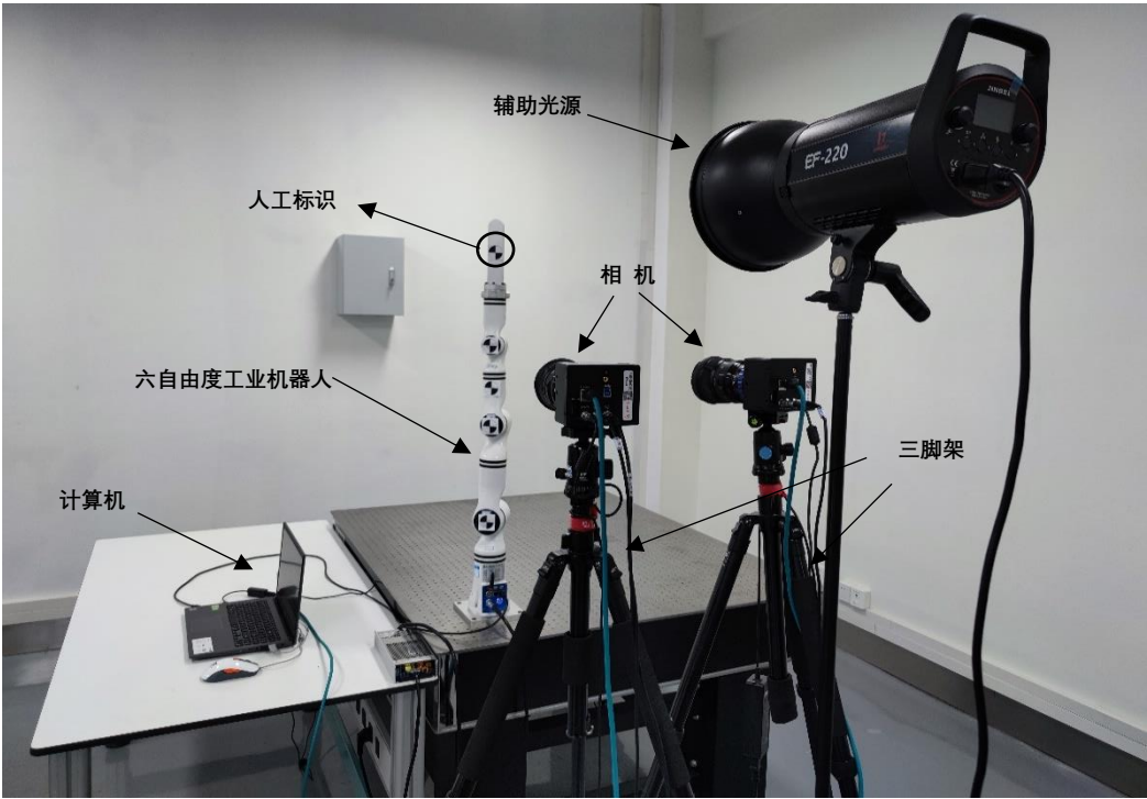
图 3-11 搭建的实验装置系统
