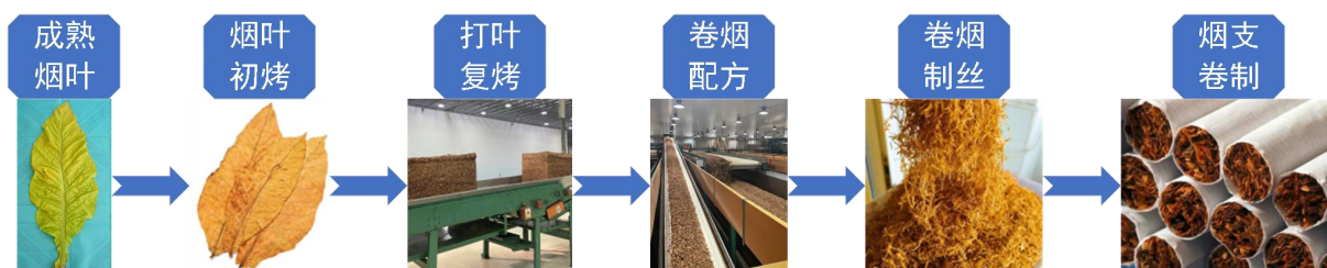
图 2-1 卷烟生产工序流程
