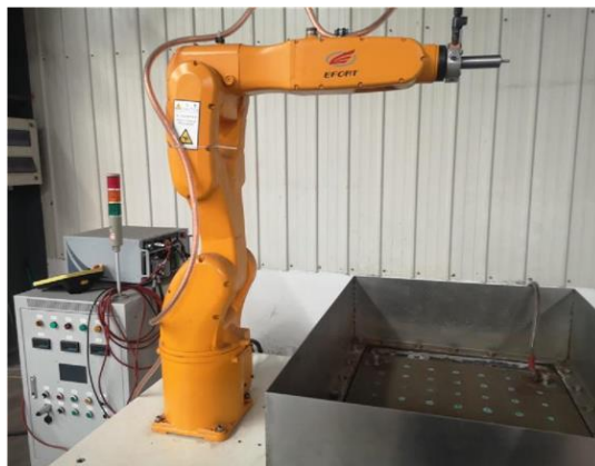
图 1-14 工业机器人的脉冲 ECM 平台 [48]
