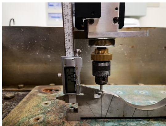
图 5-16 初始加工间隙距离测量
