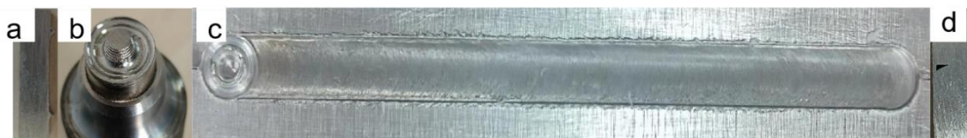
图 3-1 搅拌头及 AZ80M 镁合金搅拌摩擦连接区宏观形貌与内部截面形貌
