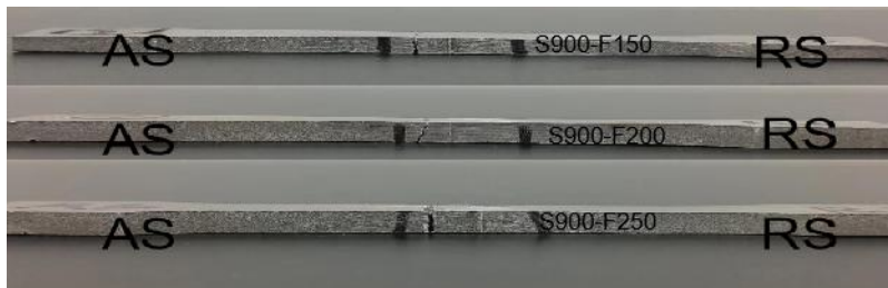
图 4-1 部分试样连接区拉伸断裂位置图
