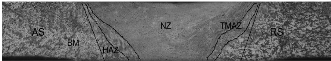
图 3-4 AZ80M 镁合金搅拌摩擦连接区横截面宏观形貌
