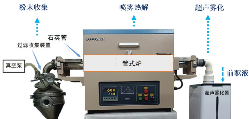
图 2-1 实验室搭建的克量级 MgO-S 载体喷雾热解合成装置图
