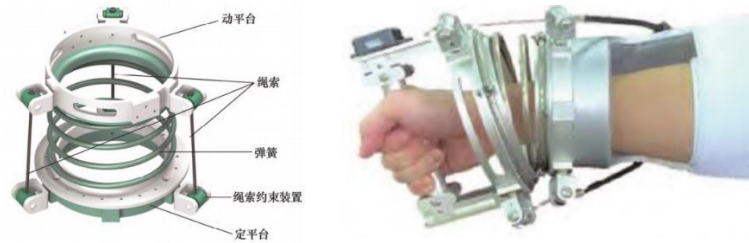
图 1-3 绳索驱动腕部并联康复机构
