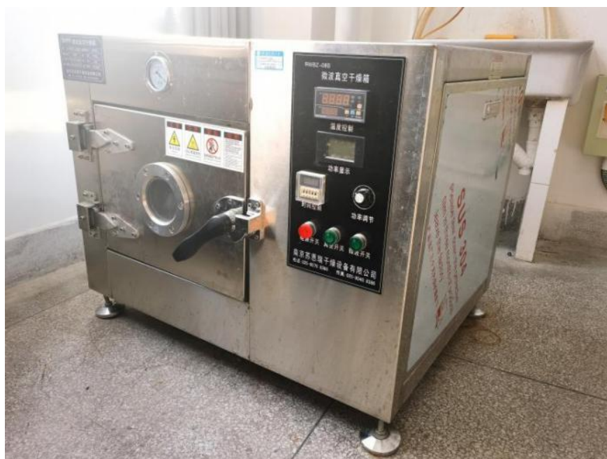
图 3-2 RWBZ-08S 微波真空干燥箱实物图
