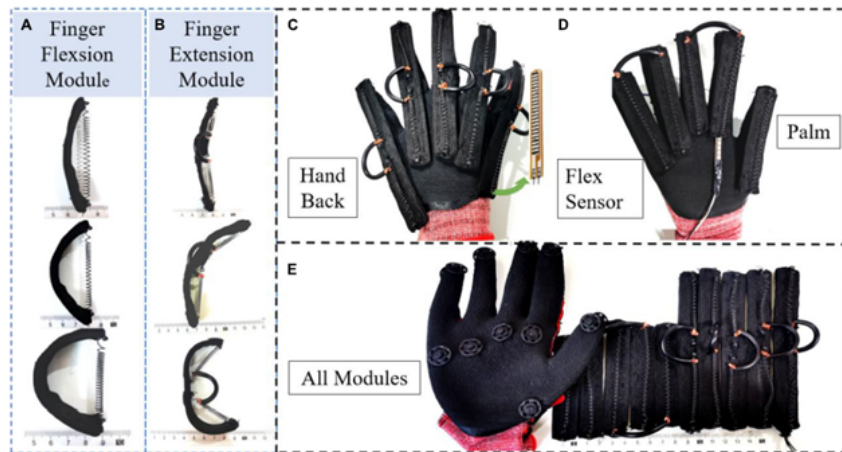
图 1-9 嵌入了记忆合金 SMA 由电流驱动的康复手套
