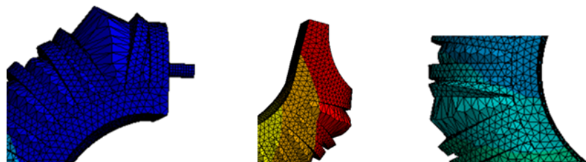
图 2-18 间隔距离 d_3 增大所产生的断裂点
