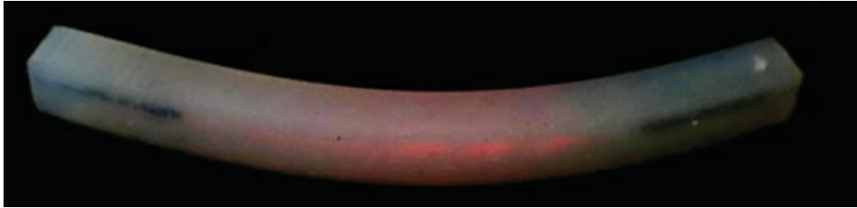
图 1-12 磨损光纤柔性传感器
