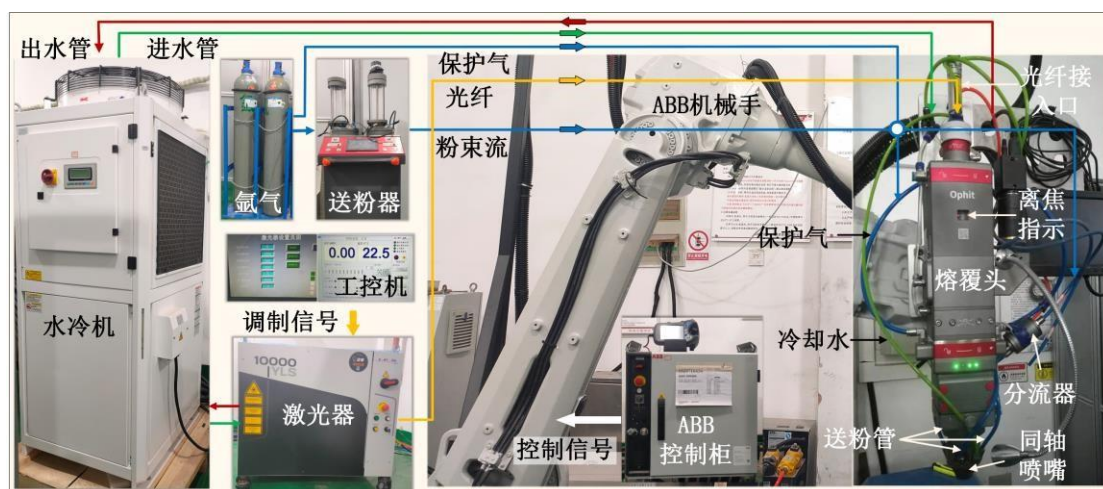
图 2-1 试验平台及材料沉积示意
