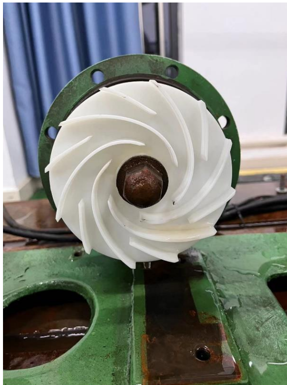
图 6-5 叶轮装配示意图
