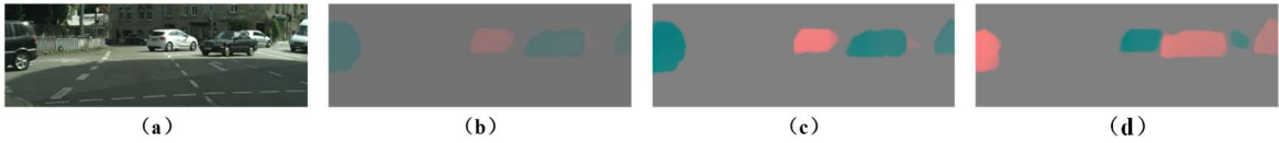
图 4-5 边缘强化模块各组分可视化结果，(a) 输入 RGB 图象、(b) 初步提取特征、(c) 经过 CBAM 后的特征、(d) 经过 CBAM 和条状卷积后的特征
