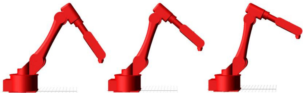
图 2-4 机器人竖向搬运位姿示意图
