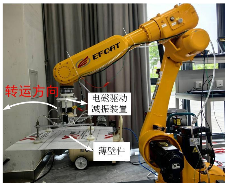
图 5-10 机器人转运弹性薄板振动控制实验运动示意图
