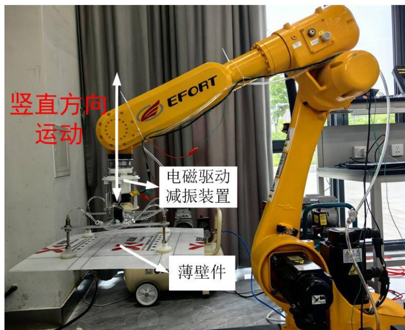
图 5-9 机器人竖直搬运弹性薄板振动控制实验运动示意图
