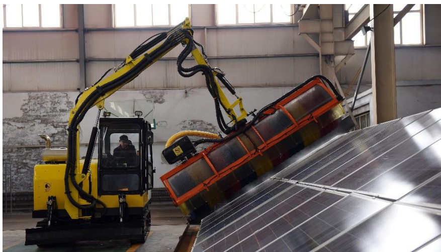
图 1-10 车载式光伏清扫车
