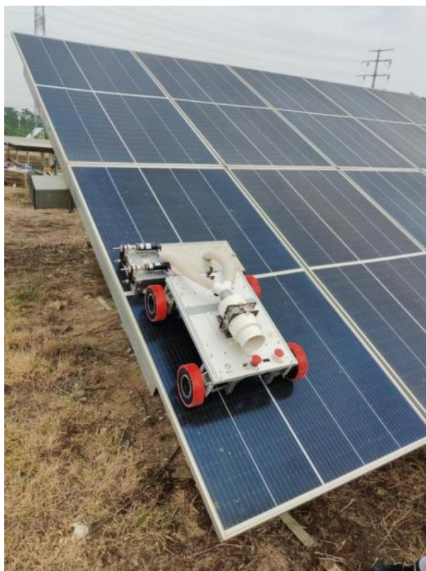
图 5-8 斜面吸附实验
