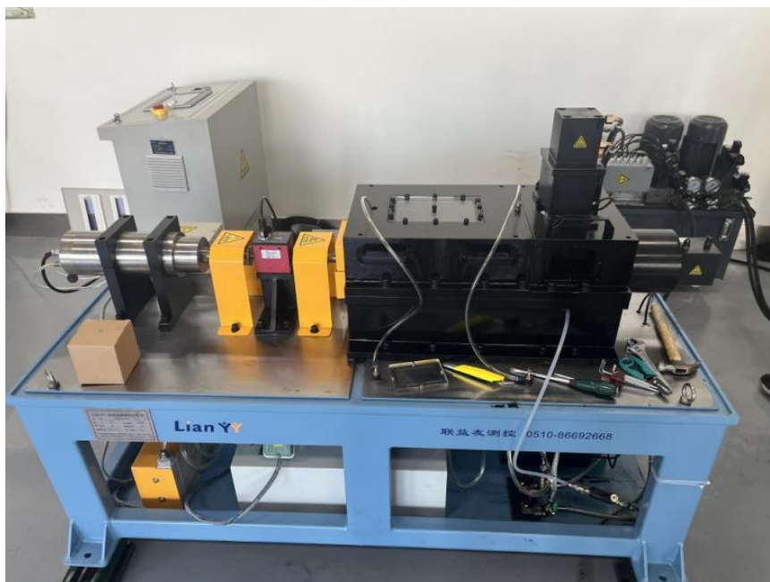
图 5-1 轴承试验台装置图
