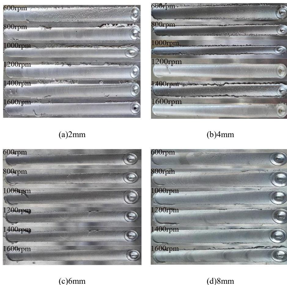
图 3-1 不同搅拌头旋转速度下连接区宏观形貌
