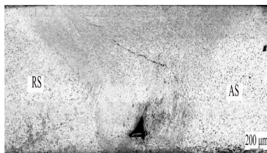
图 6-2 8mm 铝合金连接区微观组织
