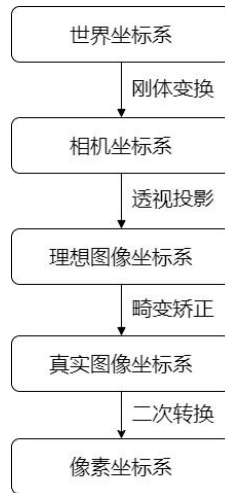
图 4-5 坐标系转换关系
