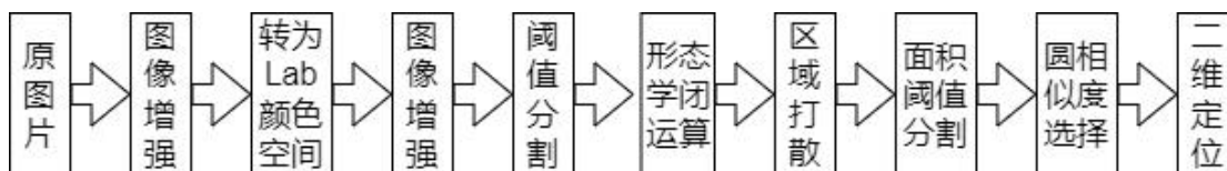
图 4-1 二维定位流程
