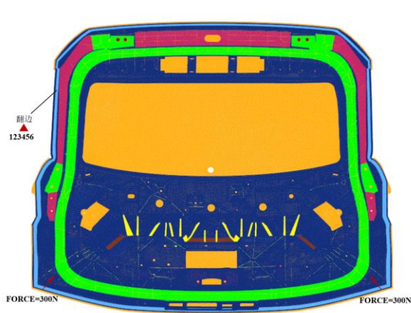
图 3-22 缓冲块安装点刚度的约束与载荷
