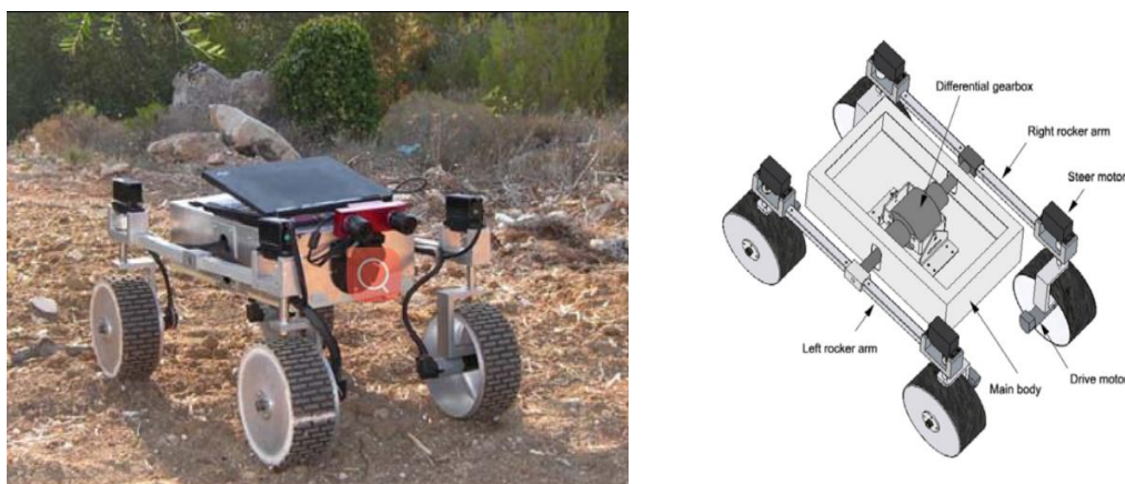
图 1-7 被动摇臂式悬挂移动机器人 [22]
