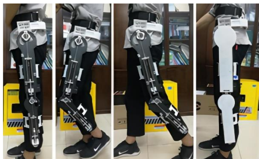
(a) 弯曲弹簧重力平衡外骨骼机器人 [12]
