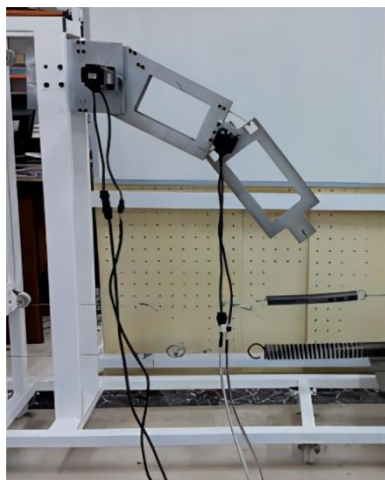
(a) 串联机械臂间接配重法 [33]
