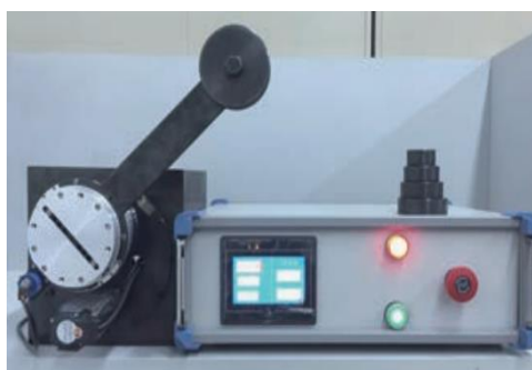
图 1-8 平面关节式静平衡机械手 [55]
