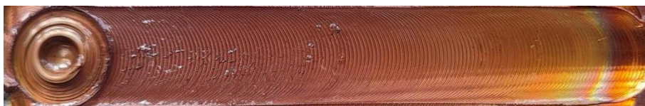
图 3-2 使用改良后搅拌头加工得到的加工表面
