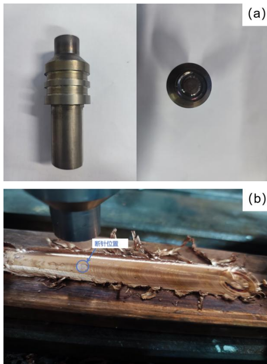
图 3-1 断针搅拌头及加工表面
