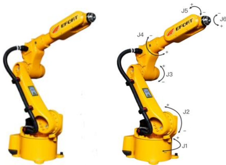
图 2-1 ER10-1600 机器人本体和各轴运动方向布置
