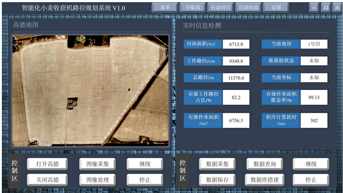
图 4-9 智能化小麦收获机路径规划系统 V1.0
