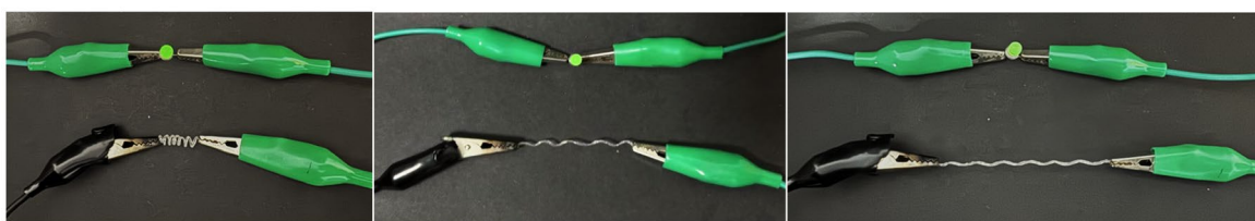
图4-11 LED 灯泡亮度随离子凝胶纤维拉伸变化的光学照片
